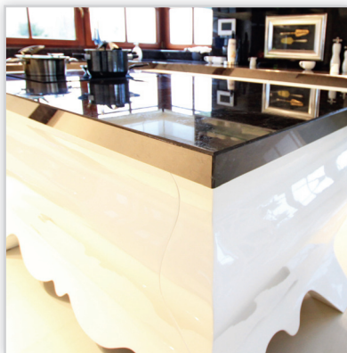
Blat kuchenny – wykonany z granitu, widoczna grubość blatu 10 cm, krawędź pod kątem 60° dopasowana do krzywizny mebla. W skład realizacji wchodzi blat kuchenny U-kształtny oraz wyspa.
